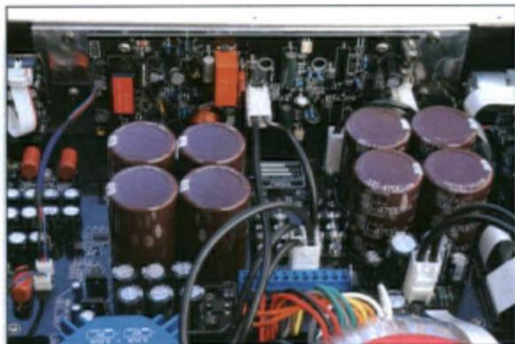
Deux cartes de redressement et filtrage sont raccordées aux secondaires du torique, créant dès lors une alimentation indépendante vers les étages audio de chaque canal.
