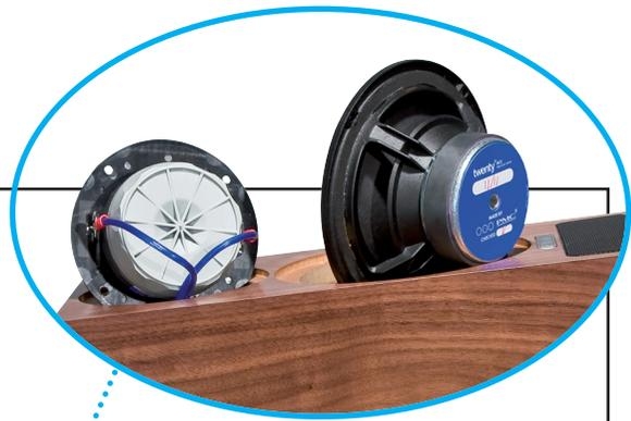
Des transducteurs spécifiques sont mis à contribution. On notera la taille généreuse des ferrites ainsi que la qualité du saladier en aluminium injecté, à la forme très aérée, offrant une bonne dissipation de l'onde arrière de la membrane du woofer.
